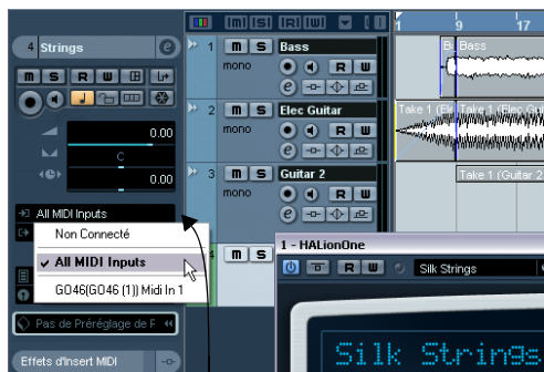
Le menu local de routage des entrées MIDI.
