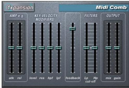
Dies ist ein Kammfilter, das eine oder mehrere kurze Verzögerungen mit hohem Feedback erzeugt, wodurch auf einigen Frequenzen Resonanzspitzen entstehen. Der Effekt »MIDI Comb« benötigt eingehende Audio- und MIDI-Signale. Das PlugIn wird als Insert-Effekt auf einen Audiokanal angewandt, es sind jedoch die Signale von einer MIDI-Spur, die den Effekt auslösen.
