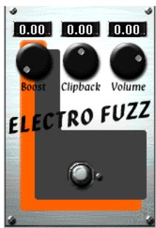
Dieser Effekt simuliert den guten alten Transistor-Verzerrer. Er lässt nur eine Monoeingabe zu und wird als Insert- oder Send-Effekt eingesetzt.
