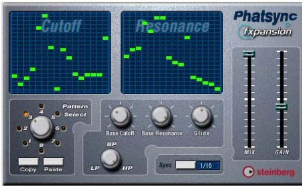
Phatsync ist ein Pattern-gesteuerter Multimodus-Filtereffekt, der rhythmische pulsierende Filtereffekte erzeugt.
