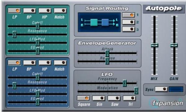
Autopole ist ein Filter-Effekt mit zwei separaten Filtern, die in vier unterschiedlichen Modi angewandt werden können, einem Hüllkurven-Generator (Envelope Generator) und einem LFO (Niederfrequenzoszillator) mit vier unterschiedlichen Wellenformen. Darüber hinaus können Sie im Bereich »Signal Routing« einstellen, wie ein eingehendes Signal durch die Filter geleitet wird (drei Modi stehen zur Verfügung).
