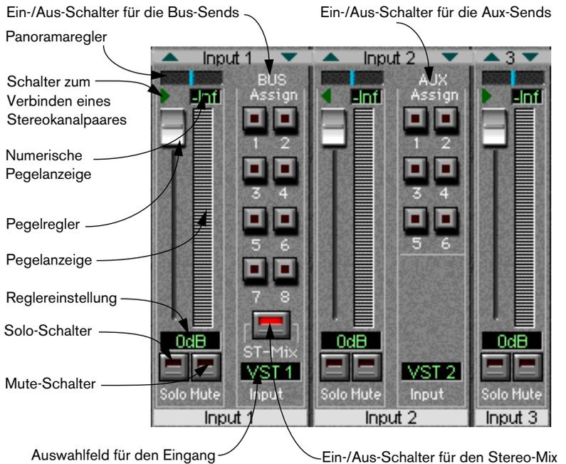
Der untere Anzeigebereich in den Modi »Bus Assign«, »Aux Assign« und »Narrow«.
