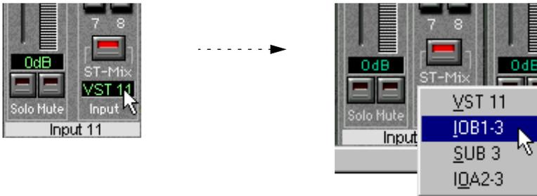
In der folgenden Tabelle wird angezeigt, welche Eingänge für jeden DS-Kanal ausgewählt werden können. Eingänge von zusätzlichen I/O-Geräten erhalten die Namen »IOA1«, »IOA2«, »IOB1« oder »IOB2«. »A/B« gibt an, ob das Gerät als Gerät A oder B angeschlossen ist,
