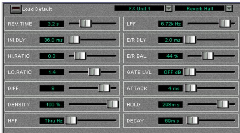
In diesem Fenster können Sie verschiedene Effektarten auswählen und Einstellungen für die beiden Effekteinheiten (»FX Unit 1« und »FX Unit 2«) vornehmen, die sich auf der Karte befinden. Sie können dieses Fenster über das Geräte-Menü oder durch Klicken auf den Schalter »FX Show« im Fenster »DSP-Factory Input Console« öffnen.
