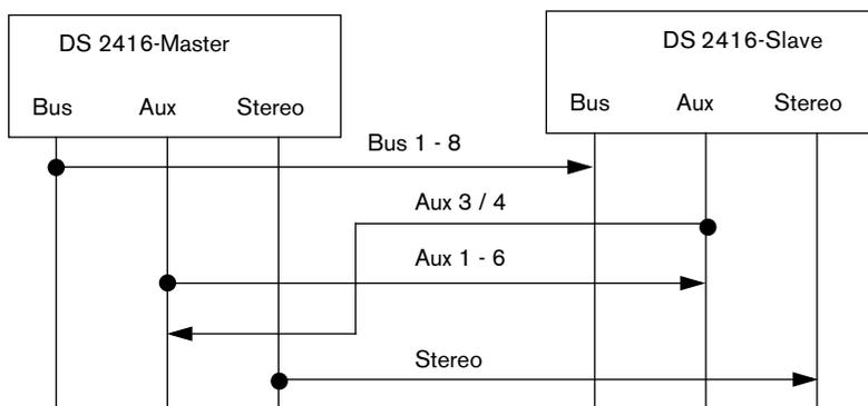
Die Busse, Aux-Sends und Stereo-Mix-Kanäle auf der Slave-Karte erhalten die Signale, die zusammengemischt werden, von den entsprechenden Bussen auf der Master-Karte. In umgekehrter Richtung werden nur die Aux-Sends 3 und 4 der Slave-Karte mit dem Aux-Bus der Master-Karte verbunden. Dadurch kann auf alle vier Effektseinheiten von allen Kanälen aus zugegriffen werden, wie weiter unten beschrieben wird.
