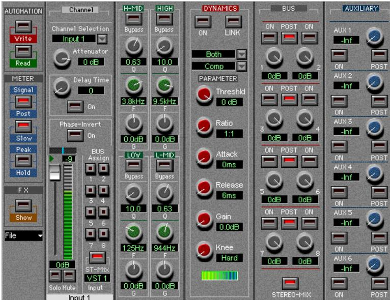
Öffnen Sie das Fenster »DSP-Factory Channel Overview«. Hier können Sie für einen einzelnen Kanal alle Steuerelemente gleichzeitig anzeigen lassen und auf sie zugreifen. Wählen Sie den gewünschten Kanal aus dem Einblendmenü »Channel Selection« in der oberen linken Ecke aus. Die Steuerelemente im Fenster »DSP-Factory Channel Overview« sind die gleichen wie im Fenster »DSP-Factory Input Console«. Zusätzlich gibt es folgende Parameter:
