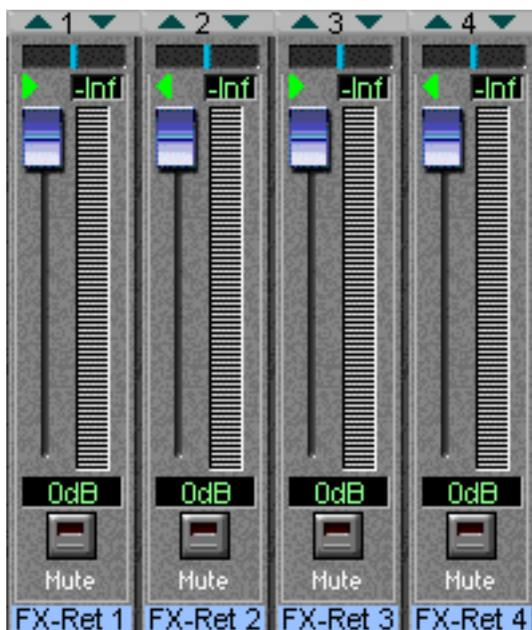
Die Kanäle 1-4 rechts im Fenster »DSP-Factory Input Console« werden standardmäßig als Rückgabekanäle für Stereoeffekte für die integrierten Effekteinheiten verwendet. Die Effektrückgabekanäle 1 und 2 steuern den Ausgangspegel der Effekteinheit 1 (FX Unit 1), und die Effektrückgabekanäle 3 und 4 steuern den Ausgangspegel der Effekteinheit 2 (FX Unit 2). Die Effektrückgabekanäle unterscheiden sich wie folgt von den herkömmlichen Kanälen:
