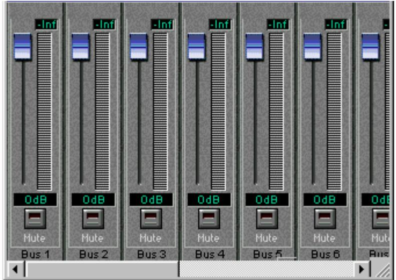
Öffnen Sie das Fenster »DSP-Factory Bus/Aux Console«. Hier befinden sich die Masterpegel-Steuererelemente für die acht Busse und sechs Aux-Sends, Pegelanzeigen und numerische Pegelanzeigen. Außerdem gibt es für jeden Bus/Send einen Mute-Schalter.
