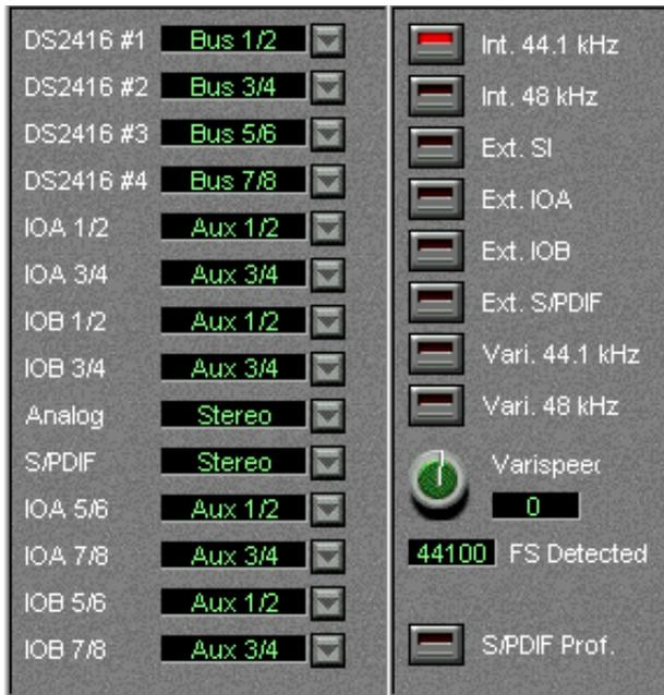
In diesem Fenster können Sie die Weiterleitung von Ausgangssignalen (z. B. welche Busse und Sends an welche Ausgänge weitergeleitet werden) anzeigen lassen und ändern. Außerdem enthält dieses Fenster Einstellungen für die Word-Clock-Synchronisation, wenn Sie die DSP Factory zusammen mit externen, digitalen Aufnahmegegeräten oder anderer Audio-Hardware verwenden.
