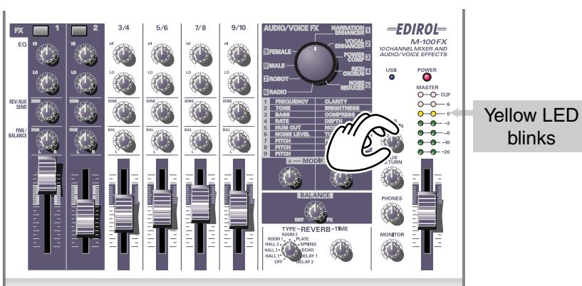
Se sono stati collegati diversi apparecchi a più prese d'ingresso linea per registrarli, aumentare il livello degli **attenuatori del livello d'ingresso** di tutti questi canali per regolarne il livello.
