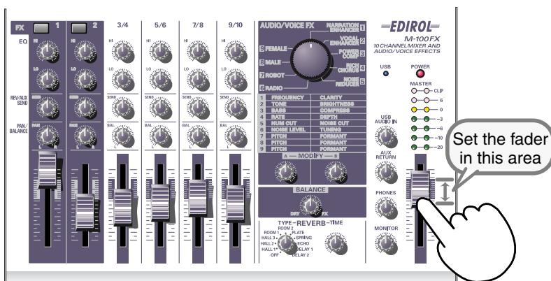
2. Durante la riproduzione dell'audio sul computer, ruotare lentamente la **manopola del livello d'ingresso USB** verso destra per aumentare il livello. Impostare un valore tale che il LED (0 dB) giallo dell'**indicatore di volume master** si illuminini di tanto in tanto.
