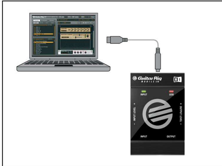
USB を介してGUITAR RIG MOBILE I/O へと電源が供給されます。この機器を正常に作動するには単体のUSB 2.0 コントローラー、または電源を供給するUSB 2.0 ハブの使用が必須です。
