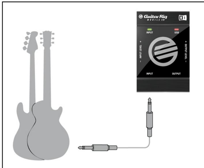
インターフェイスを使用して十分な音量を維持しつつ音質を最適な状態に設定するには、GUITAR RIG MOBILE I/O のインプットレベルを注意深く設定する必要があります。
