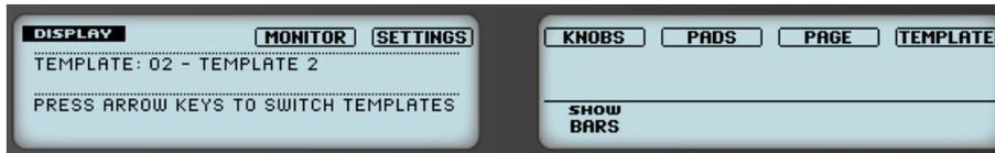
Die Displays Ihres MASCHINE-Controllers im MIDI-Modus bei gedrücktem SHIFT-Button.
