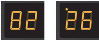
L'affichage 7-segments affichant 82 (à gauche) et 126 (à droite).
