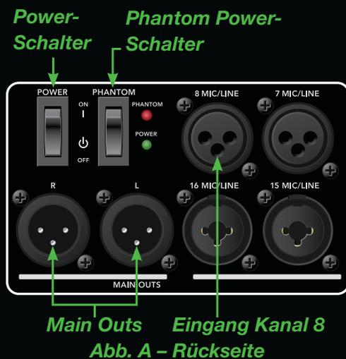
1) Schließen Sie das Mikrofon an den Eingang von Kanal 8 an [Abb. A]; ja, wir überspringen einfach die Kanäle 1 – 7... raten Sie, was jetzt kommt?!
