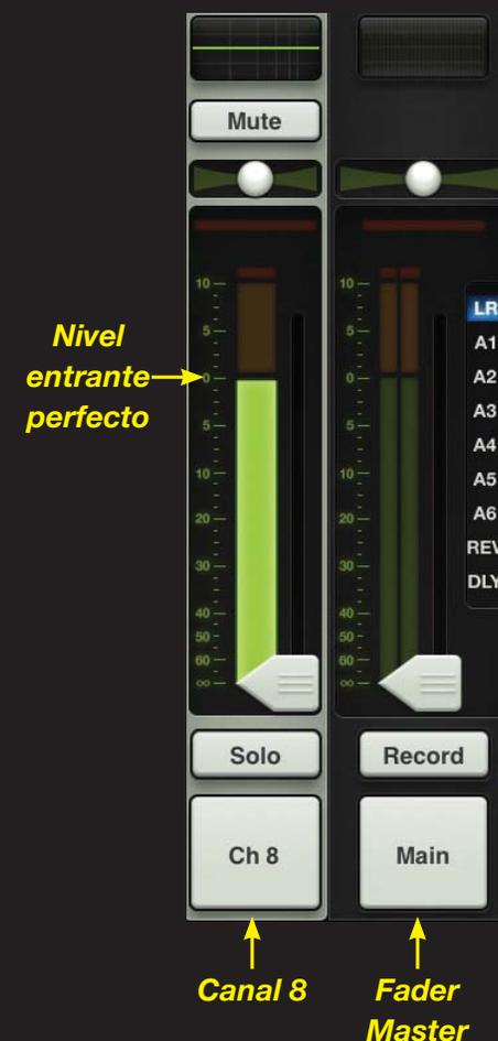
**Figura G – Vista del mezclador:**
