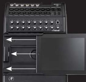
¿Está usando un iPad de primera generación? Basta con retirar los cuatro tornillos de la bandeja de inserción de DL1608, sacar dicha bandeja y colocar los tornillos de nuevo en la bandeja. Ahora es posible deslizar el iPad en el DL1608 como se ha descrito anteriormente.
