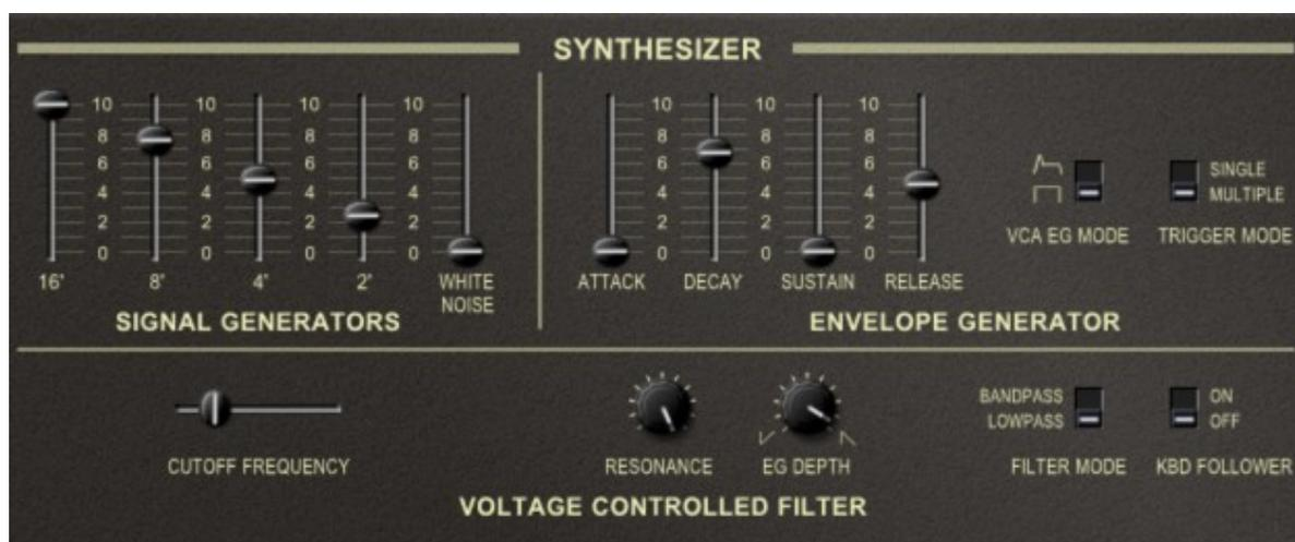
La section Synthesizer est le cœur même du Nabla. Elle dispose d'un oscillateur polyphonique, d'une section de filtre et d'amplification. Elle possède également une enveloppe ADSR qui contrôle la fréquence de coupure du filtre et/ou l'amplitude, un LFO pour la modulation du Vibrato ou de la fréquence de coupure du filtre. Cela reprend un peu le design classique du Juno-6 n'est-ce pas ?
