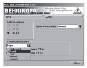
Fig. 2.2: Impostazioni del pannello di controllo ASIO-USB
