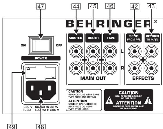
**42** Микшер DJX700 предлагает коммутационную петлю для подключения внешних устройств обработки. Мониторный сигнал снимается с выхода SEND и направляется, например, на процессор реверберации. Сигнал на разъемах SEND идентичен сигналу наушников и выбирается кнопками MONITOR CUE **16**.
