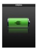
「充電中」画面が表示されない場合は、iPod nano が高電力型 USB ポートに接続されていない可能性があります。コンピュータの別の USB ポートで試してください。
