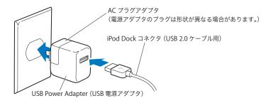
**警告**:プラグをコンセントに差し込む前に、電源アダプタが完全に組み立てられていることを確認してください。
