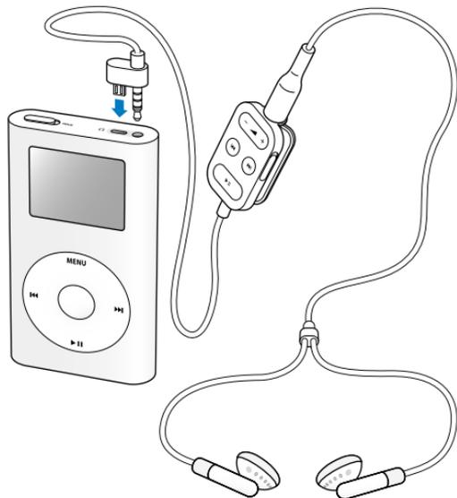
Utilisez le bouton Hold pour désactiver les boutons de la télécommande. Si une bande orange apparaît, la télécommande est réglée sur Hold. Le fonctionnement du bouton Hold de l'iPod mini ne gêne pas celui de la télécommande iPod mini Remote, et inversement.
