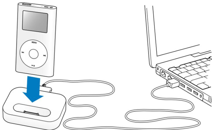
**Remarque :** assurez-vous que les connecteurs du câble sont correctement orientés. Chaque connecteur ne peut être inséré que dans un sens.
